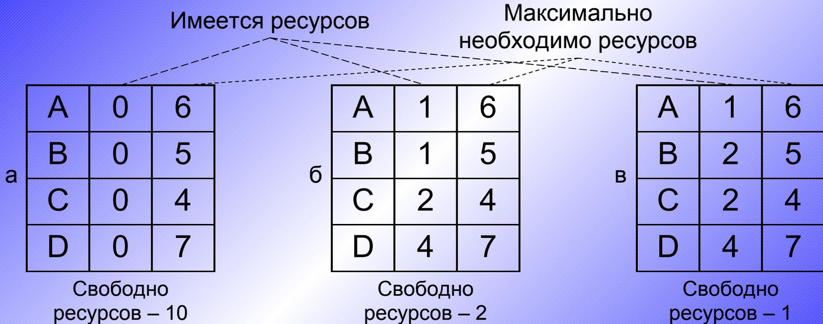
Состояния (а) и (б) – безопасные, состояние (в) – небезопасное. Алгоритм исключения взаимоблокировок состоит в проверке безопасности состояния при каждом запросе на ресурс и выдаче этого ресурса только в случае, если это приведёт к безопасному состоянию.
