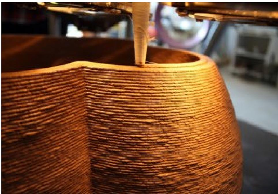
Компания WASP недавно установила самый большой на сегодняшний день 3D-принтер Big Delta. Этот 12-метровый гигант был построен с целью строительства здания с почти нулевой себестоимостью, за счет использования местных материалов и значительного сокращения энергопотребления. Как полагают разработчики, возведение жилья с помощью 3D-принтера Big Delta станет самым бы-
