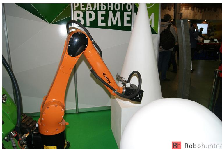
На стенде российской компании Quantum Systems был манипулятор KUKA, запрограммированный на формообразование кустов. Компания на примере робота-садовника представила технологии высокоточного определения координат и ориентации и генерирования траекторий движения промышленного манипулятора в режиме реального времени. Обработка 3D облаков точек позволяет добиться определения координат с точностью более пяти миллиметров на пятьдесят метров, рассказывают разработчики.
