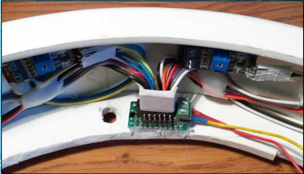
Соорудил такую конструкцию, чтобы не тянуть от каждого датчика по три провода ▲ к основной плате. Получилось вместо 18 проводов, всего 8, шесть сигнальных и два питания.
