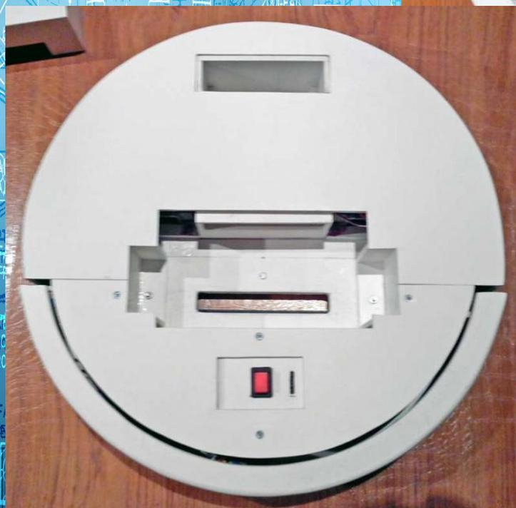
На передней крышке выключатель и разъем для подключения программатора.
