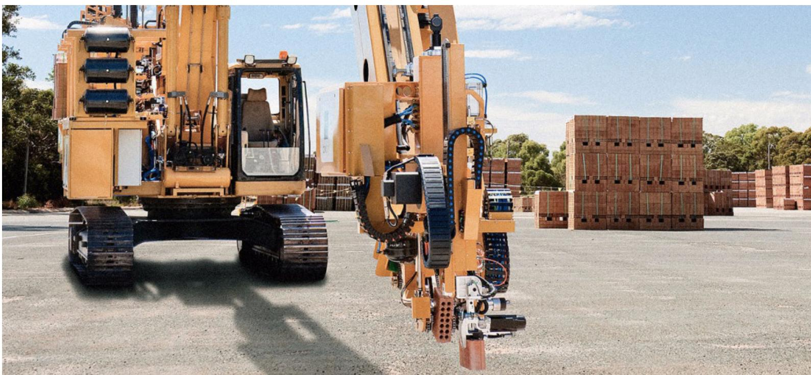
ся). Гигантская рука робота движется, опираясь на фиксированные метки, которые берут информацию из проекта дома в приложении 3D CAD. Он автоматически исправляет себя 1000 раз в секунду, чтобы предотвратить помехи от вибрации или электричества. Также есть лазеры для триангуляции положения, но все это звучит очень сложно.
