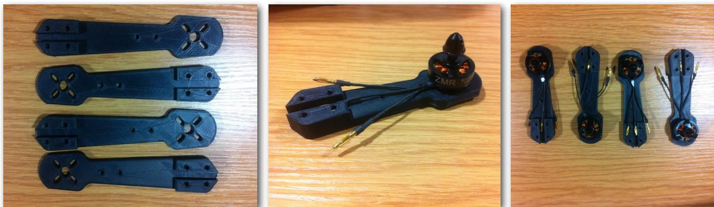
2. Предварительно к моторам и регуляторам ESC были припаяны коннекторы. Делается это для того, чтобы легко изменить направление вращения мотора, поменяв 2 из 3 проводов от «ески». Можно выполнить пайку напрямую без переходников, но это немного муторнее и опаснее, когда опыта нет. Паяльником пользовался впервые, поэтому такая практика пайки 12 пар коннекторов оказалась очень полезной.
