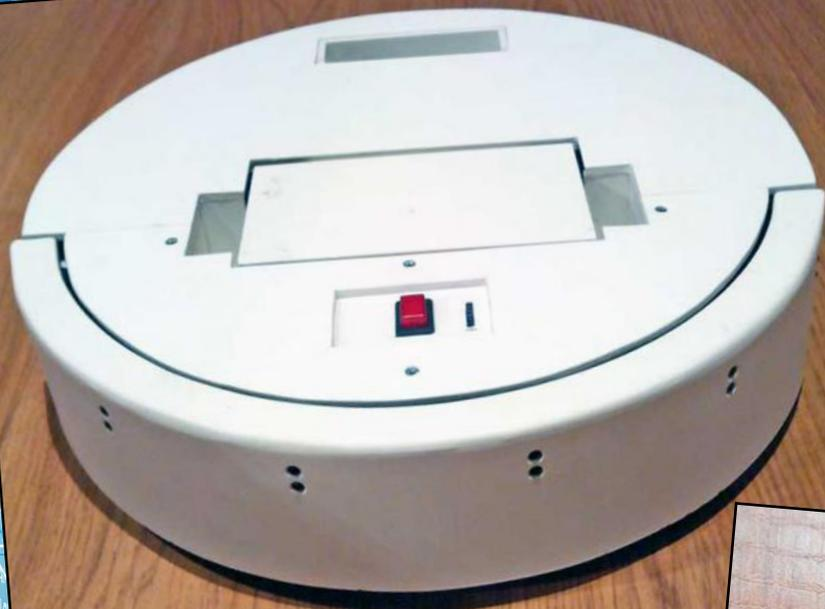
Диаметр робота 34 сантиметра, высота 9 сантиметров. Корпус робота сделан из вспененного ПВХ толщиной 4 мм.
