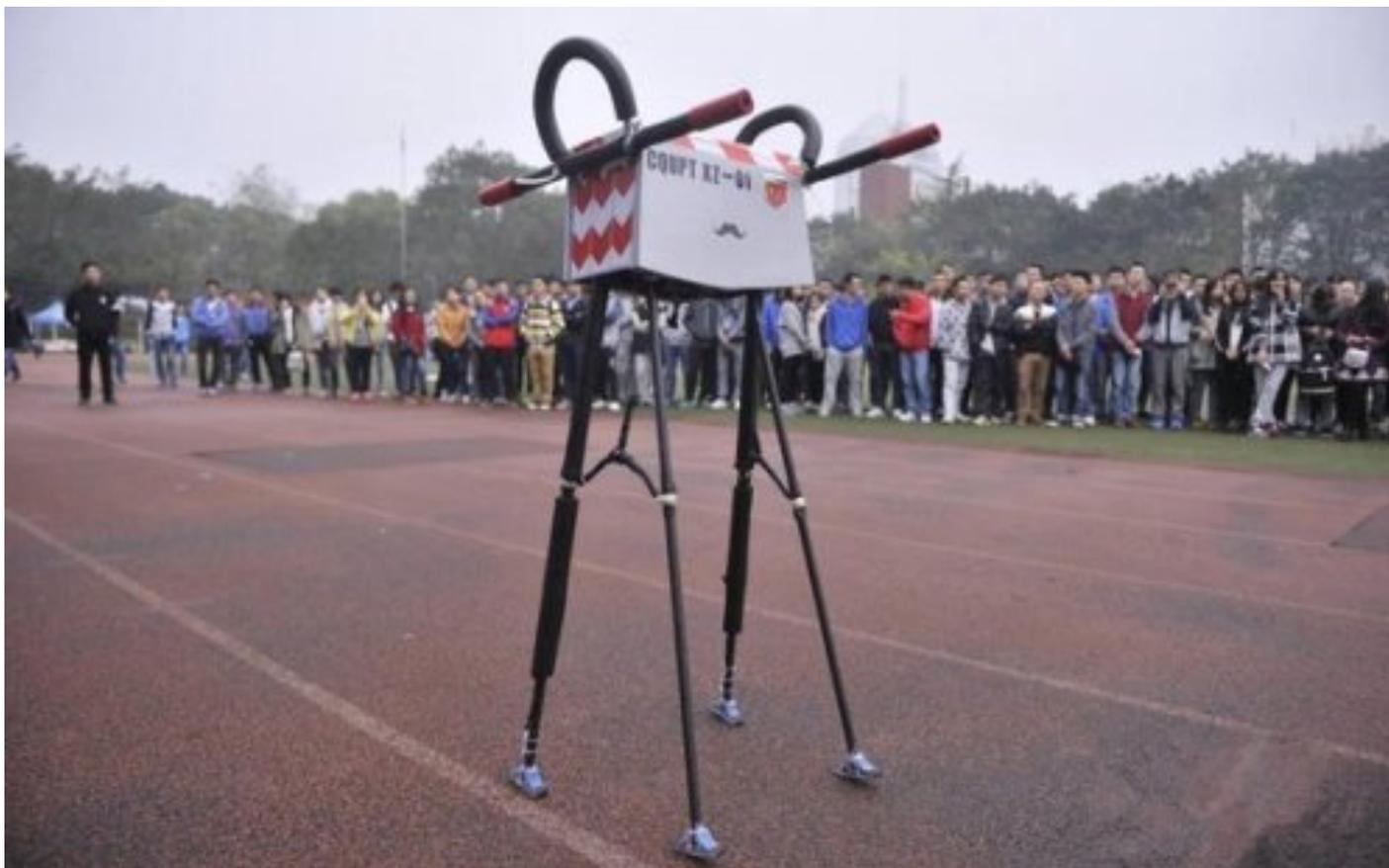
порядка 360 тысяч шагов, пройдя в общей сложности 134.03 километра (83 мили). Конструкция робота Xingzhe No.1 весьма подобна конструкции еще одного шагающего робота, Ranger Robot, созданного специалистами из Корнуэльского университета. В 2001 году робот Ranger прошагал более 65 километров (40 миль) за 31 час, истратив на это 0.5 кВт/ч энергии. Китайскому же роботу для того, чтобы преодолеть в два раза боль-
