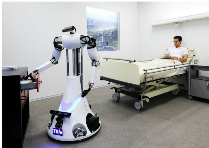
Чтобы продемонстрировать возможности сети RoboEarth, инженеры создали четырех роботов, которые должны были совместно ухаживать за пациентами в специально оборудованной больничной палате. Один из «докторов» скачивал из «облака» карту палаты и передавал её другим роботам, которые, в свою очередь, искали пути и разносили пациентам напитки.
