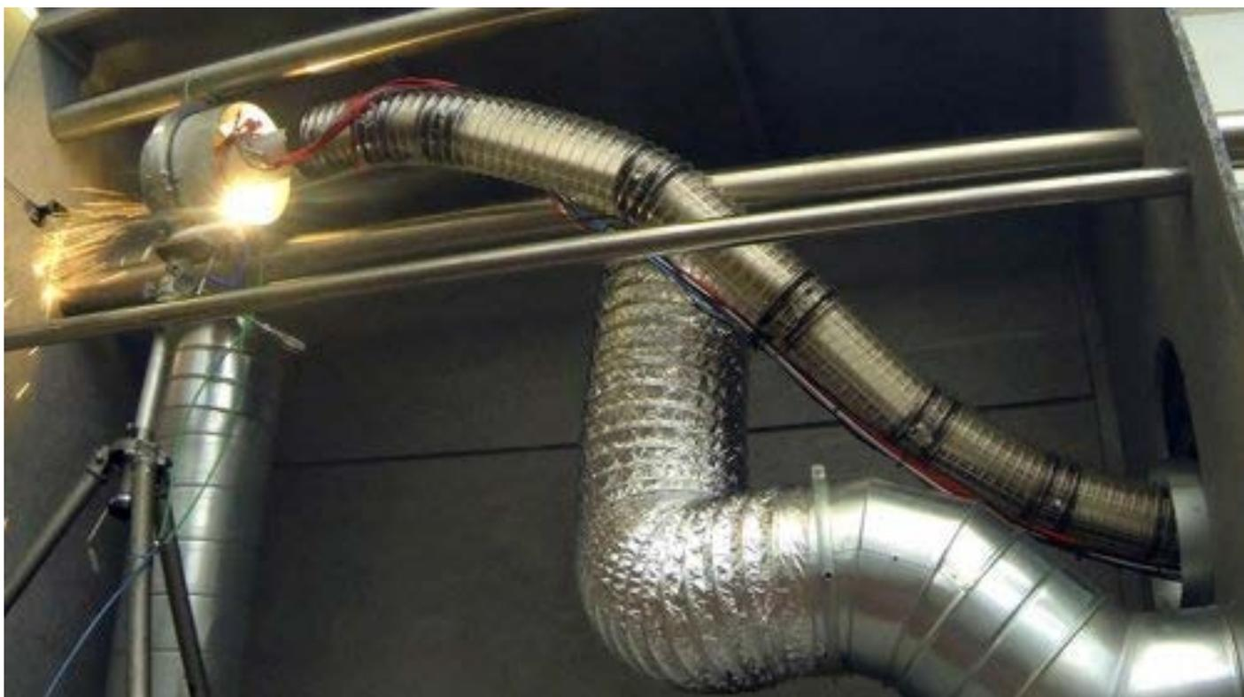
Для решения проблемы автоматизации процесса сварки труб в условиях тесных помещений или на опасных для жизни людей объектах специалисты компаний OC Robotics и TWI Ltd разработали специализированного робота-змею LaserPipe. За счет своей гибкой природы этот робот может действовать изнутри прокладываемого трубопровода, сваривая секции труб при помощи мощного промышленного лазера.
