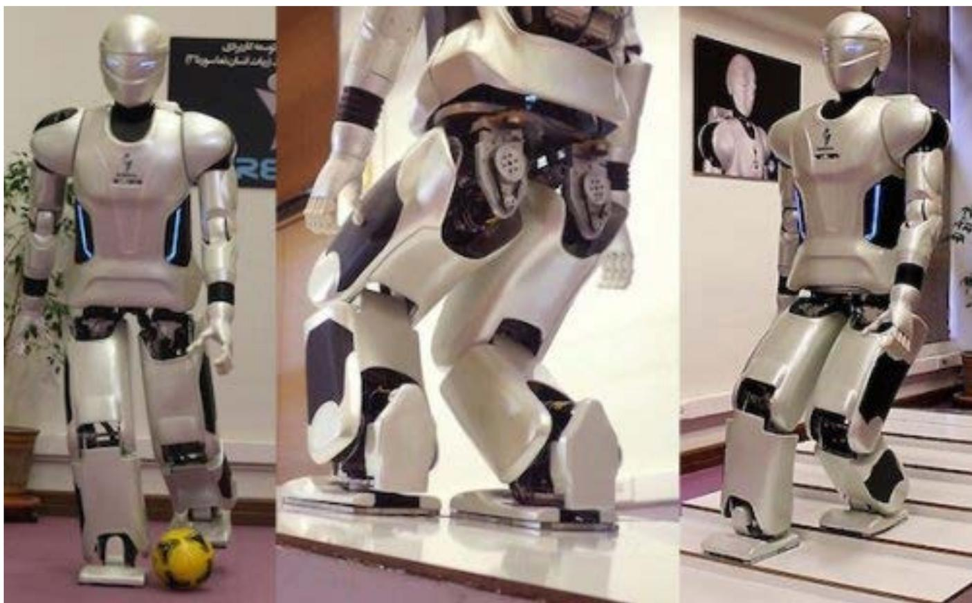
ли конструкцию предыдущего варианта, приводы и набор датчиков. Нынешняя система видения позволяет роботу не только видеть предметы, но и распознавать лица, определять жесты и движения людей. Кроме этого, система способна распознать некоторые управляющие слова и
