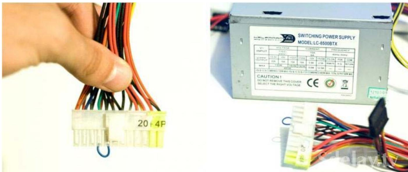
Следующий шаг заключается в подготовке питания для того, чтобы использовать его для нашего проекта. Прежде всего, мы соединяем два провода друг с другом (как указано на рисунке), чтобы было прямое питание с выключателем на подставку. После этого мы выбираем один желтый (12V) и один черный провод (GND) для питания контроллера.
