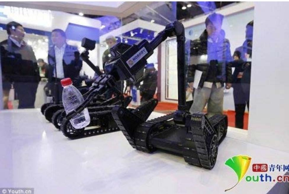
вания. Вес робота-разведчика и робота EOD составляет порядка 12 килограмм и их без труда может переносить в специальном рюкзаке на спине солдат.
