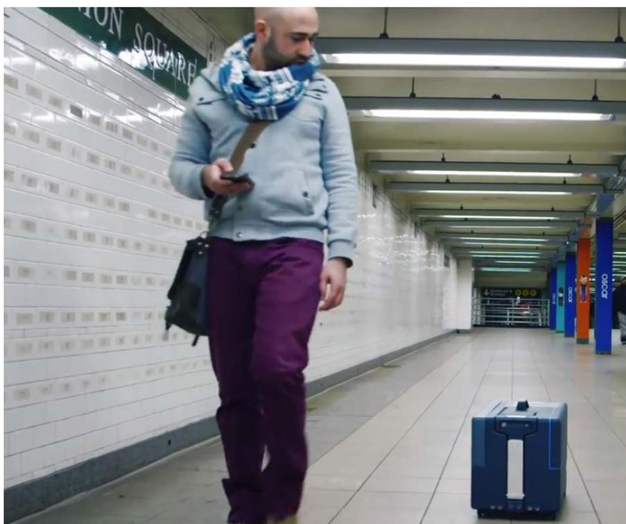
Израильская компания NUA Robotics продемонстрировала прототип робота-чемодана, который неотрывно следует за владельцем. Он способен огибать препятствия, а управление происходит посредством смартфона. Сейчас компания активно ищет новых партнеров для сотрудничества.
