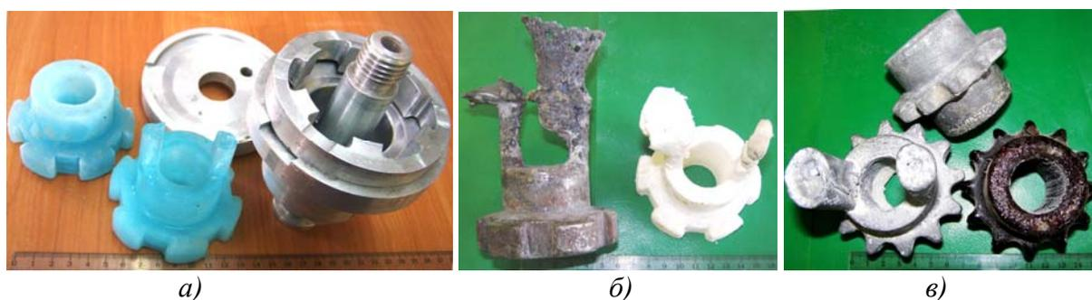
Рис. 5. Ледяные модели: а, б - модели полумуфт, с открытой пресс-формой (а), с отливкой (б); в - модель шестерни с двумя отливками.
