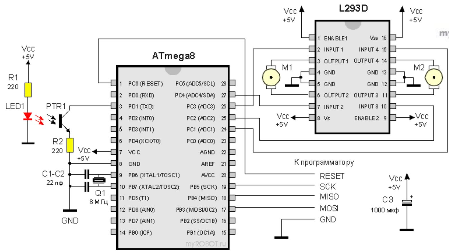
Схема работа с фотодатчиком
