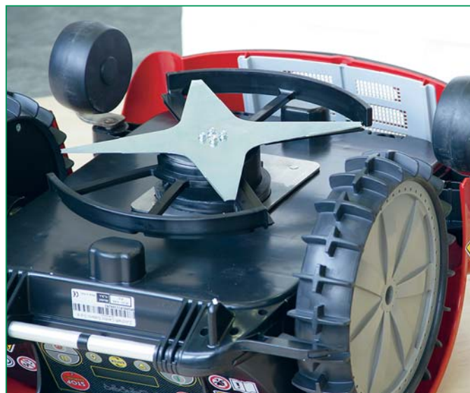
Острый 4-лопастный нож снабжён специальной дугой безопасности. Впрочем, это не единственный элемент защиты: на рукоятках стоят специальные датчики, отключающие нож, если коснуться рукояток
