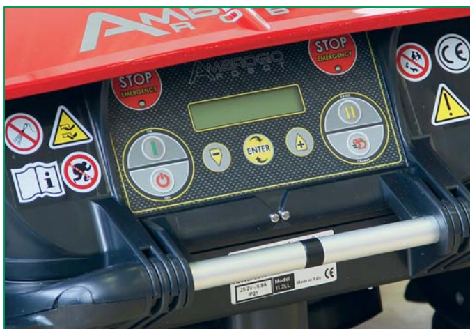
Панель управления достаточно простая, но при этом позволяет программировать множество настроек, включая различные режимы работы. Упрощает процесс русифицированный дисплей
