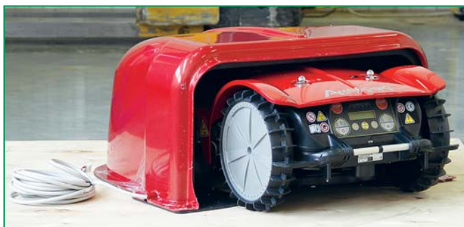
При разряде батареи робот сам возвращается на базовую станцию для подзарядки
