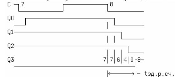
Выходной код в течение интервала  $t_{зд.р.сч}$  принимает недопустимые значения (6,4,0). Скорость деления частоты входного сигнала не зависит от количества триггеров и определяется максимальной частотой переключения входного триггера, т.е.  $F_{макс.деления} < 1/(t_{зд.р.триггера} + t_{уст})$  и больше  $F_{макс.сч}$ .
