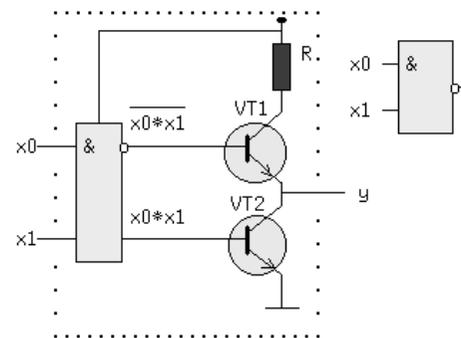
Напряжения на базах транзисторов VT1 и VT2 находятся в противофазе и, если  $x0 * x1 = 1$ , то нижний транзистор открыт, а верхний закрыт, так как  $\sim (x0 * x1) = 0$ . Потенциал коллектора VT2 в этом случае примерно равен нулю и следовательно  $y = 0$ . При других значениях  $x0$  и  $x1$  нижний транзистор закрыт, а верхний открыт и на выходе схемы - высокий уровень, т.е. схема работает как элемент И-НЕ. Выходы нескольких БЛЭ
