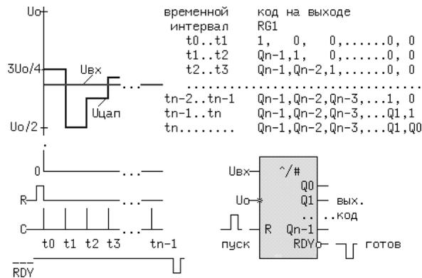
По этому принципу действия выпускаются преобразователи типов 572ПВ1 и 1113ПВ1(А..В). Зависимость прямого двоичного кода D от входного напряжения:  $D = \lfloor (U_{вх} * 2^n) / U_0 \rfloor$ , где D десятичный эквивалент кода на входе АЦП.
