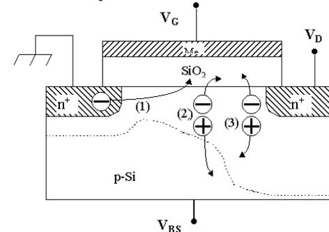
Рис. 6.7. Инжекция горячих электронов в диэлектрик МДП-транзистора и другие процессы, проходящие при лавинном пробое подложки. Лавинный пробой подложки вблизи стока может привести к неоди-
