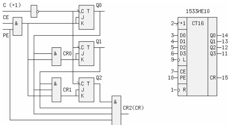
Быстродействие синхронного счетчика значительно выше, из-за того, что триггеры переключаются одновременно и сигнал  $CR_i$  появится на JK входах через интервал  $t_{зд.р.сч.} = t_{зд.р.триггера} + t_{зд.р.элемента\ "И"}$ , который не зависит от числа триггеров. Частота счета  $F_{max} < 1/(t_{зд.р.сч.} + t_{уст})$ . Максимальная частота деления  $F_{max.деления} = F_{max.счета}$ .
