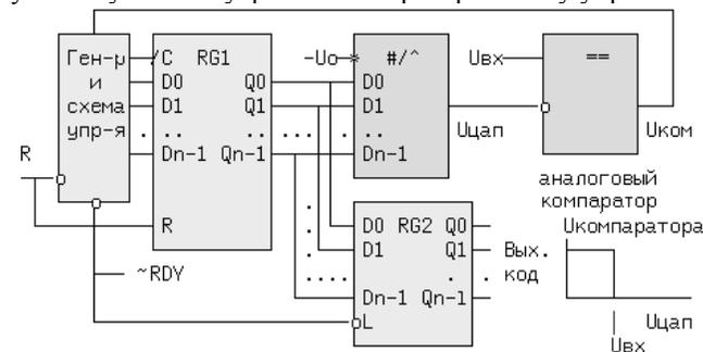
В момент  $t_0$  в старший разряд регистра RG1 записывается лог."1" (гиря с наибольшим весом). На выходах регистра RG1 появляется код  $10..00(\text{BIN}) = 2^{(n-1)} = 512$ . ЦАП генерирует напряжение  $U_{\text{цап}}(n-1) = U_0 * 2^{(n-1)} / 2^n = U_0 / 2$ . Аналоговый компаратор сравнивает напряжения, и если  $U_{\text{цап}}(n-1) \leq U_{\text{вх}}$ , то единица в старшем разряде сохраняется, если  $U_{\text{цап}}(n-1) > U_{\text{вх}}$ , в старший разряд записывается ноль.
