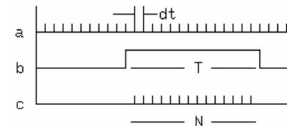
Частота повторения импульсов на входе "a" равна по определению: F = 1/dt. Из диаграмм "b" и "c" можно найти период повторения dt = T / N, с погрешностью dt / T. Тогда F = N / T и при T = 1с частота F = N. Диапазон измерения находится в пределах: (1...(10^6)-1)Гц. Для измерения длительности импульса на вход "a" необходимо подать сигнал с частотой F = 10^i (i=2,3,..), например F = 10^6[Гц]. Длительность импульса T = N \* dt = N / F и диапазон ее измерения равен (1..999999)мксек.
