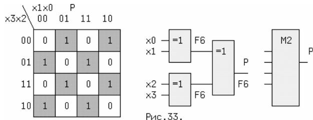
Символом M2 обозначена операция - "сумма по модулю два". Четыре строки таблицы Карно дают 4 составляющих:  $P = \sim x3 * \sim x2 * F6(x1, x0) + \sim x3 * x2 * \sim F6(x1, x0) + x3 * x2 * F6(x1, x0) + x3 * \sim x2 * \sim F6(x1, x0) = F6(F6(x3, x2), F6(x1, x0)) = (x3 (+) x2) (+) (x1 (+) x0)$ . Рассмотрим пример на рис.34.
