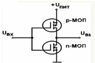
Рис. 6.1. Схема КМОП инвертора.
