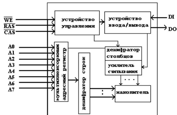
Рис. 6.5. ОЗУ с произвольной выборкой. а) ОЗУ 16x4 бит; б) ОЗУ 64Kx1 (KP565PY5)
