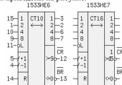
В некоторых счетчиках предпочтительней иметь один тактовый вход и вход управления направлением счета. Для этого к входам "+1" и "-1" подключают демультиплексор "1 в 2". В этом случае, если управляющий сигнал  $U/\sim D = (U_p/\sim \text{Down}) = 1$ , тактовые импульсы С поступают на вход суммирования, а если он равен нулю - на вход вычитания. Счетчик такого типа приведен на рисунке внизу.
