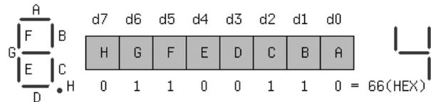
Внизу приведен битовый набор для высвечивания цифры 4. Единицы обычно соответствуют светящимся сегментам.
