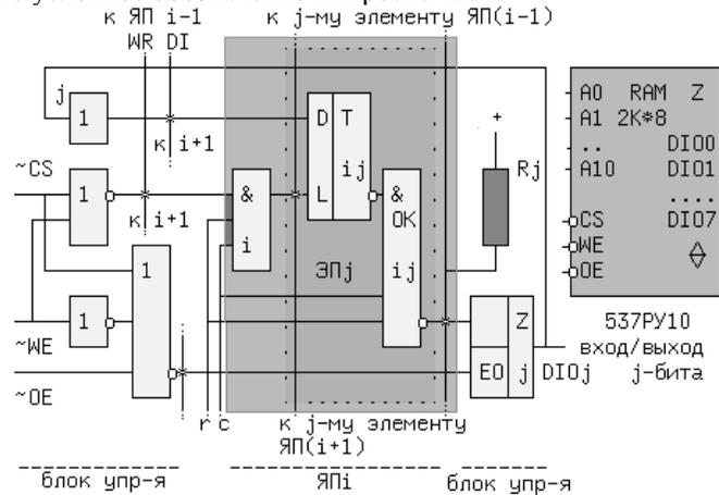
На рисунке схемы с открытым коллектором и третьим состоянием обозначены ОК и Z - соответственно. Точками выделен один (j-ый) из восьми элементов i-ой ячейки памяти. Схема И с номером  $i = (r * 2^k + c)$  является одним из  $2^n$  выходных узлов прямоугольного дешифратора, где  $r$  и  $c$  - номера строк и столбцов матрицы. Инверсный вход (Chip Select) -  $\sim CS$ , во всех микросхемах, где он встречается, служит для приведения схемы в рабочее состояние низким уровнем сигнала на этом входе.
