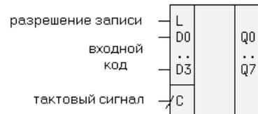
Устройства (в том числе регистры), в которых для записи входного параллельного кода  $D_i$  необходим, во-первых, сигнал разрешения записи  $L$  и, во-вторых, перепад синхросигнала на тактовом входе  $C$  - называются устройствами с *синхронной параллельной записью кода*.
