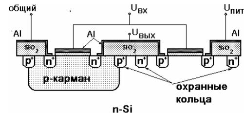
Рис. 6.2. Конструкция инвертора на КМОП транзисторах.
