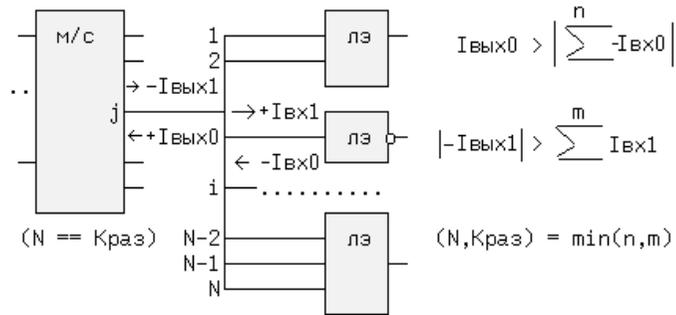
Для определения N находят отдельно две суммы входных токов для логического 0 и 1 на j-выходе. Минимальная сумма и будет Краз. m, n - целые значения.
