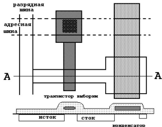
Рис. 6.4. Конструкция ячейки ДОЗУ. Снизу представлен разрез схемы по линии А-А.
