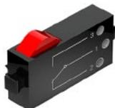
Кнопочный переключатель относится к категории датчиков осязания. Если вы нажмете на красную кнопку переключателя, то язычок внутри корпуса переместится и замкнет контакты 1 и 3, возникнет электрическая цепь и потечет ток. В это же время цепь между контактами 1 и 2 разрывается. Кнопочные переключатели имеют две различные схемы включения:
