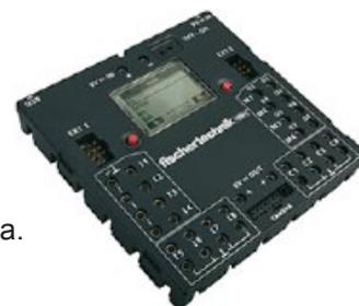
Особое внимание следует уделить беспроводному интерфейсу Bluetooth. С его помощью вы можете подключить ваш компьютер к блоку управления без кабеля. Также с помощью этого интерфейса можно подключить к компьютеру несколько блоков управления или соединить их между собой.
