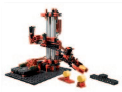
Соберите макет робота с поворотным захватом, используя инструкцию по сборке. Выполните электрические соединения согласно схеме, приведенной в инструкции.
