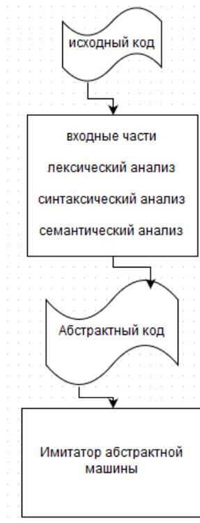
Лексический анализатор – преобразует последовательности символов в синтаксические инструкции. Синтаксический анализатор – строит синтаксические иерархические структуры (связывает отдельные компоненты).
