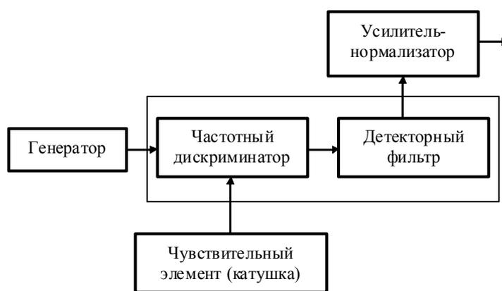
Рис. 6.2. Функциональная схема вихретокового датчика
