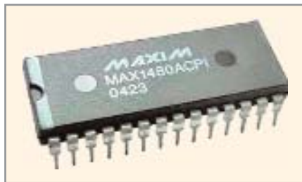
Рис. 2. Специализированная микросхема интерфейса RS-485
